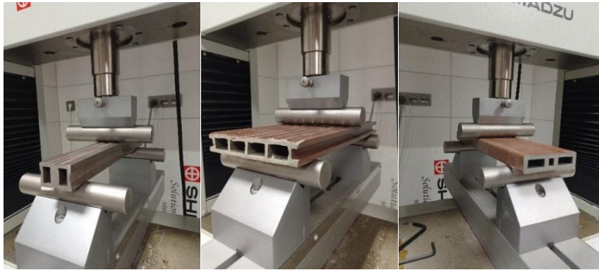
Şekil 2. Çalışmada kullanılan OPK profillerin eğilme testleri Figure 2. Bending tests of WPC profiles used in the study
