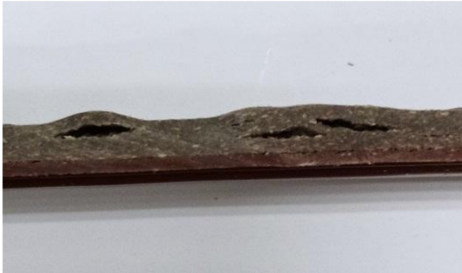
Şekil 9. P2 profilde görülen boşluklar Figure 9. Voids observed in P2 profile
