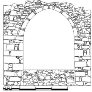
Fot.30-31/Şek.19: Zaviyenin güney taçkapısı, taçkapıdan detay ve taçkapının çizimi
