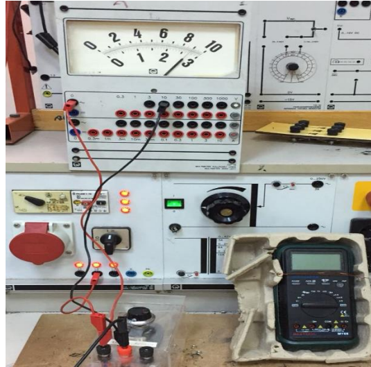
Şekil 2. Şebeke, voltmetre enversör anahtar bağlantısı (Grid, voltmeter, switch connection)
