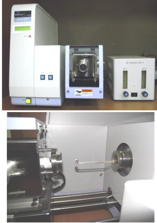
Şekil 3. Perkin-Elmer Diamond termogravimetrik analiz sistemi (Perkin-Elmer Diamond thermogravimetric analysis system)
