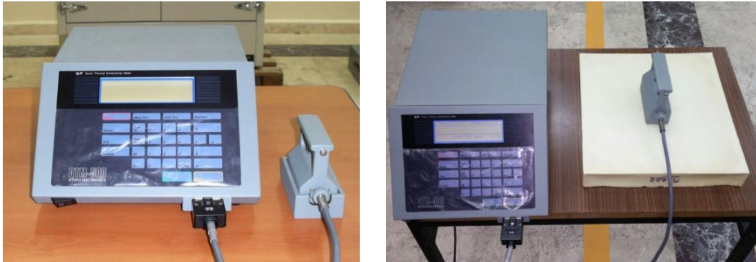
Şekil 2. Kyoto QTM-500 ısı iletim katsayısı ölçüm cihazı ve ölçümün yapılması (Kyoto QTM-500 thermal conductivity coefficient measurement equipment and the sample measurement)
