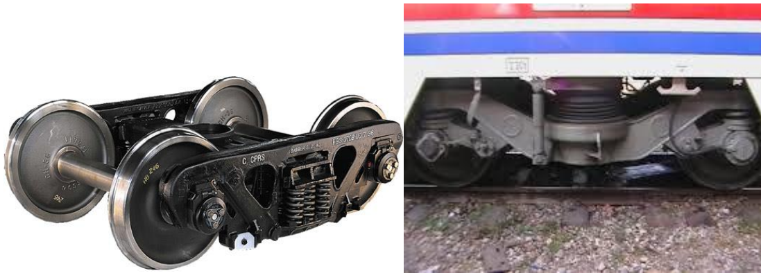
Şekil 2. Yük bojisi (soldaki) ve yolcu bojisi (sağdaki) (Freight bogie (left) and passenger bogie (right))
