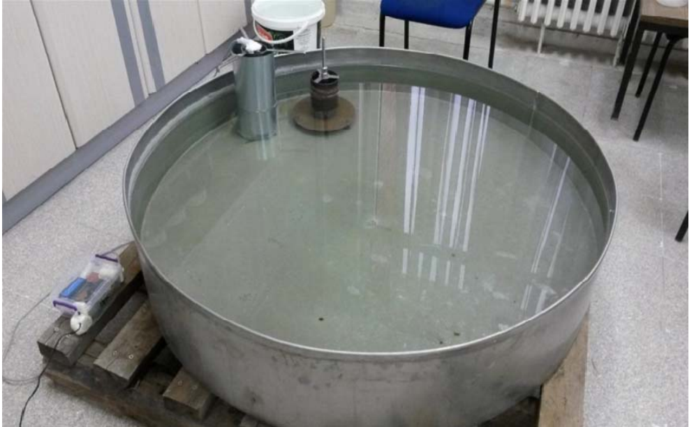
Şekil 1. A sınıfı buharlaşma kabı, mikrometre ve ultrasonik derinlik ölçer
