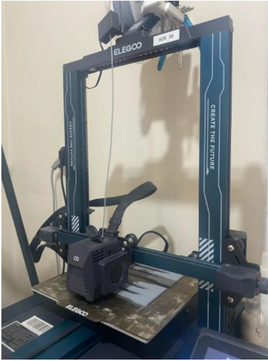
Şekil 7. PLA malzeme kullanılarak FDM yöntemiyle deney numunelerinin imalatı (ELEGOO Neptün 3 Pro)
