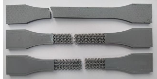
Şekil 10. PLA malzemeden imal edilmiş a) Dolu b) TC c) Kelvin test sonrası çekme numuneleri.
