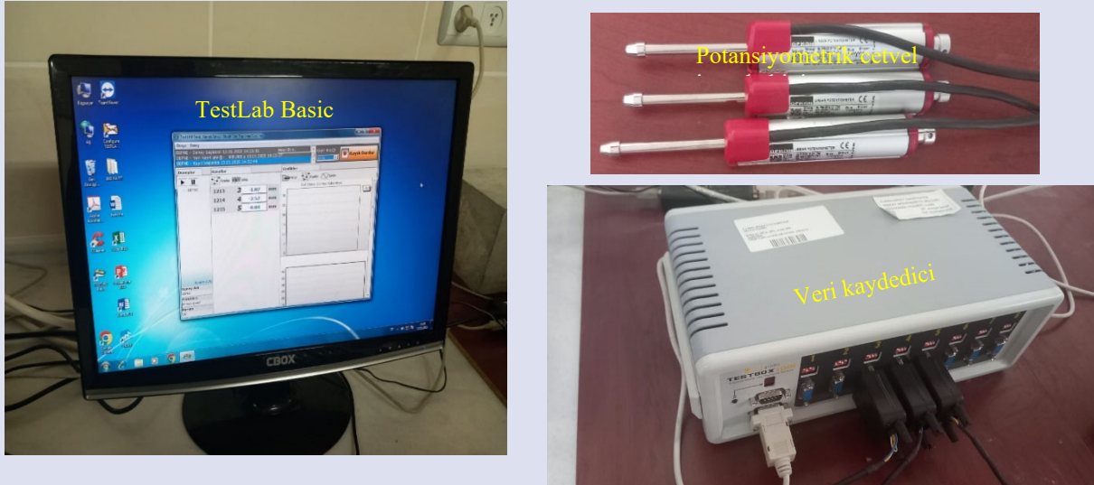
Şekil 7. TestLab Basic yazılımı, potansiyometrik cetvel ve veri kaydedici Figure 7. TestLab Basic software, potentiometric ruler and data logger
