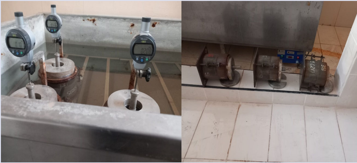
Şekil 4. CBR deneyi için hazırlanan numunelerin suda bekletilmesi ve süzülmesi Figure 4. Soaking and filtering of samples prepared for the CBR test
