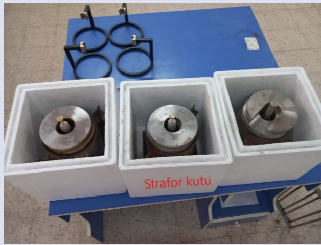
Şekil 5. CBR deneyi için hazırlanan numunelerin styrafoam kutusuna yerleştirilmesi Figure 5. Placing the samples prepared for the CBR test in the styrafoam box.
