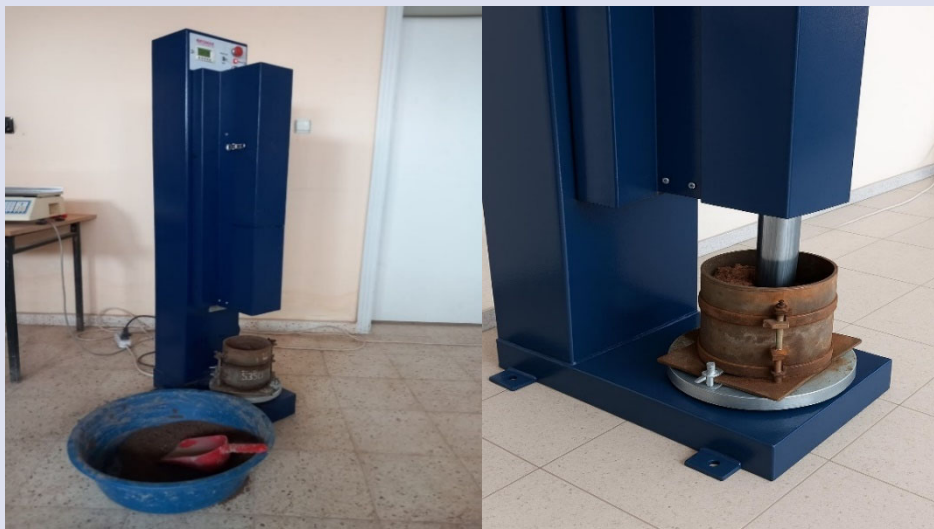
Şekil 3. Hazırlanan numunelerin sıkıştırılması Figure 3. Compression of prepared samples
