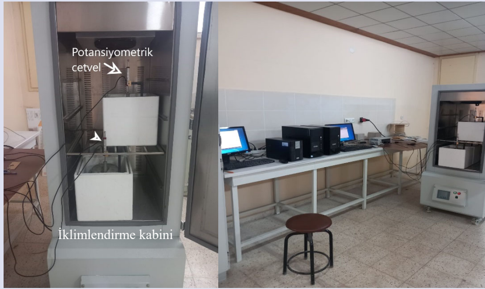
Şekil 6. İklimlendirme kabini, potansiyometrik cetvel ve veri kaydedici Figure 6. Air conditioning chamber, potentiometric ruler and data logger
