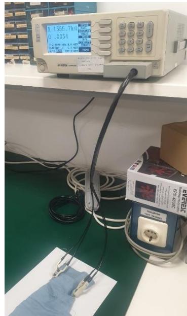
Şekil 13. GW Instek LCR-816 model LCRmetre ile direnç ölçümü Figure 13. Resistance measurement using the GW Instek LCR-816 model LCR meter
