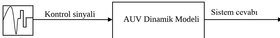
Şekil 6. Simülasyon tabanlı veri toplama şeması (Simulation-based data collection scheme)
