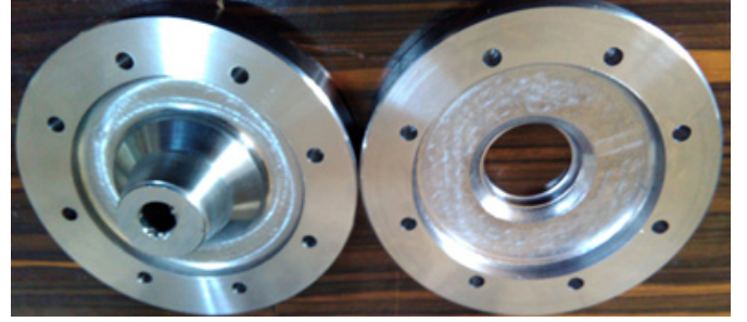
Şekil 2. Nozzle üst kapak (solda), alt kapak (sağda) olarak 610°C
