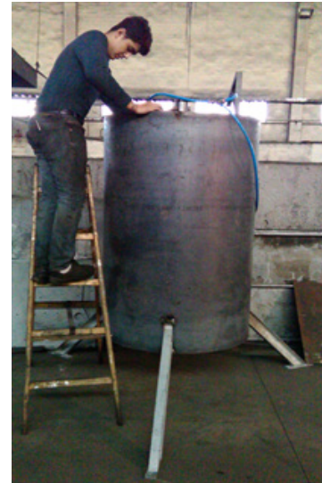
Şekil 3. Gaz atomizasyon ünitesinin a; çalışma prensibi b; atomizasyon kulesi montaj resmi
