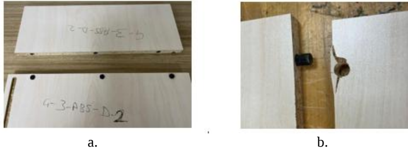
Figure 6. Failure modes in diagonal tension test a) dowel produced in vertical orientation, b) dowel produced in horizontal orientation (Diyagonal çekme testi için deformasyon karakteristikleri a. düşey yönde üretilen kavela, b. yatay yönde üretilen kavela)
