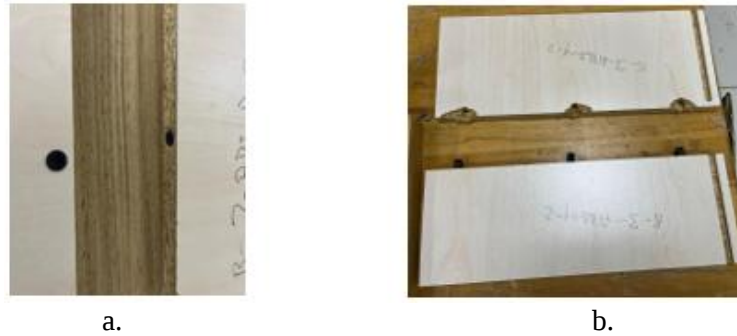
Figure 7. Failure modes in diagonal compression test a) dowel produced in vertical orientation, b) dowel produced in horizontal orientation (Diyagonal basınç testi için deformasyon karakteristikleri a. düşey yönde üretilen kavela, b. yatay yönde üretilen kavela)
