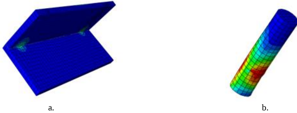
Figure 9. Failure modes in diagonal compression test for FEM a) particleboard failure mode b) dowel failure mode (Diyagonal basınç testi için deformasyon karakteristikleri a. yonga levha deformasyonu, b. kavela deformasyonu)
