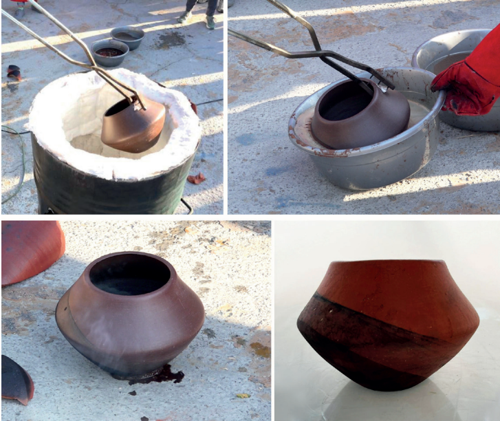
Görsel 12. “Varil fırın pişirimi ve pişirim sonrası daldırma yöntemi ile bitki solüsyonu uygulaması” (Foto. Nazlı H. Zorkun).
