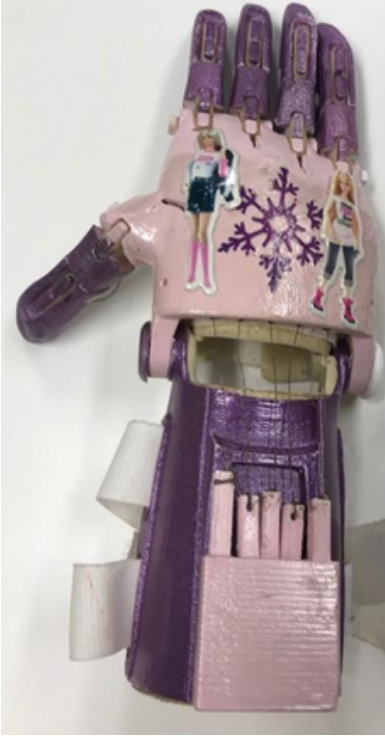
Görsel 5. ‘Frozen’ temasıyla kişiselleştirilmiş, bilekten hareketli bir Robotel örneği. Protez, 6 yaşında bir kız çocuk tarafından kullanılmıştır. Fotoğraf, araştırma sürecinde Şahinol tarafından çekilmiştir. © Melike Şahinol, 2018.
