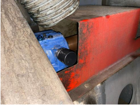
Şekil 1. Kayış/kasnak ile tahrik edilen bir vakum fanının kasnak tarafı yataklamasına monte edilmiş Able-Sens 3-eksenli kablosuz endüstriyel ivme sensörü.
