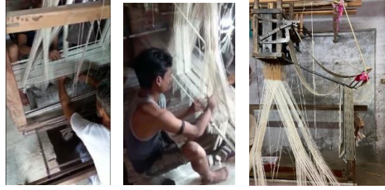
Şekil 25. Hindistan’da yerel jakarlı tezgâhlarda, desenli dokuma için gerekli olan hook plan hazırlığı aşaması (Güneş Yarmacı, 2022).
