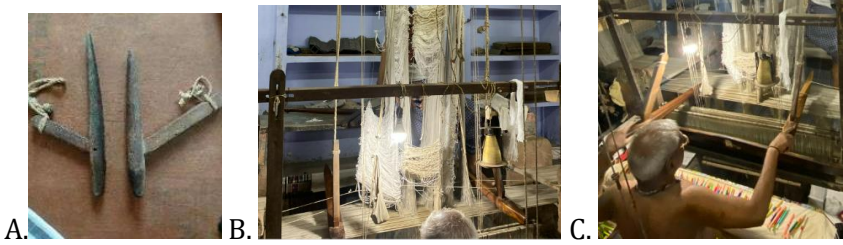
Resim 19. A. Akkada aleti, B. tezgâhtaki yeri, C. Kullanılış şekli
