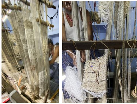
Resim 17. Jala tezgâhına desen ipliklerinin yerleşimi, Hindistan (Güneş Yarmacı, 2022).
