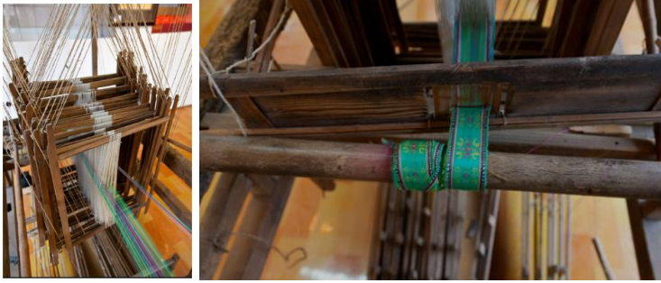
Resim 8. Çin Dingqiao tezgâhı çerçeveleri; şerit dokuma örneği (URL 4).
