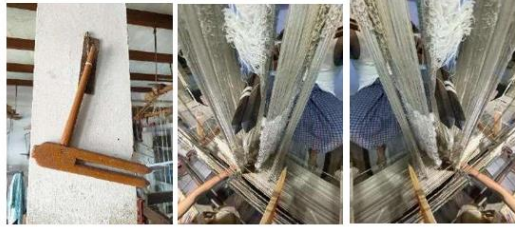
Resim 18. Desen ipliklerini kaldırmak için kullanılan Mandha aleti (Güneş Yarmacı, 2022)
