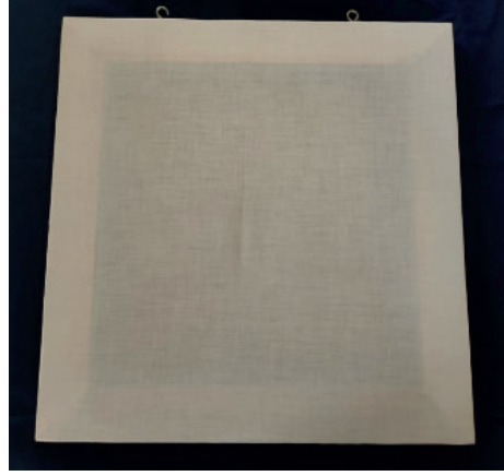
Şekil 1. Atışlarda kullanılan %30'luk balistik jelatin ve 50 x 50 %100 pamuk kumaş.
