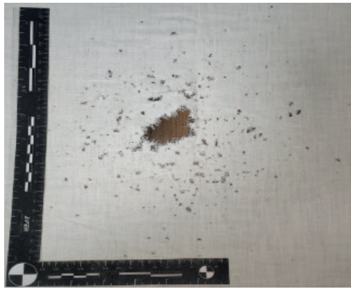
Şekil 13. 12 kalibre ses fişegi ile 150 cm'den gerçekleştirilen atışın görüntüsü.
