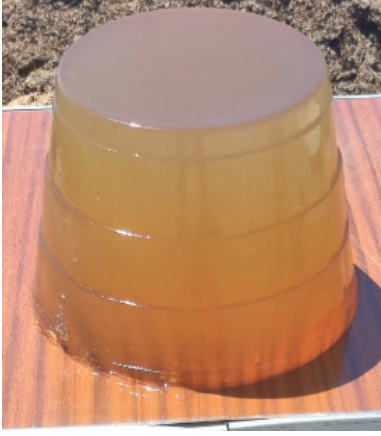
Şekil 1. Atışlarda kullanılan %30'luk balistik jelatin ve 50 x 50 %100 pamuk kumaş.
