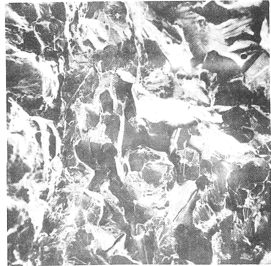
Şekil 9 Kırık yüzeylerin tarama elektron mikroskobu ile çekilen fotoğrafları: a) 70°C, b) 0°C, c) -20°C, d) -40°C, e) -60°C ve f) -80°C için
