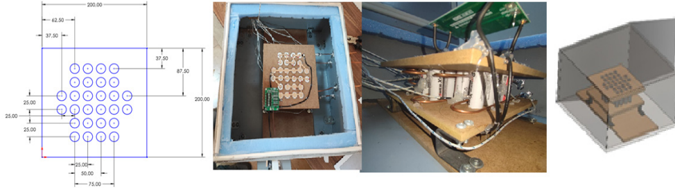
Şekil 1. Tasarlanan dizilim geometrisinde bataryaların yerleşimi ve deney düzeneği
