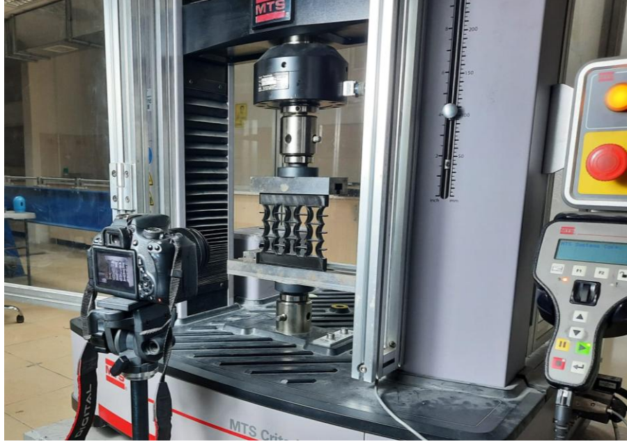
Şekil 8. Tek eksenli basma testi deney düzeneğinin ve numune yerleşiminin genel görünümü.
