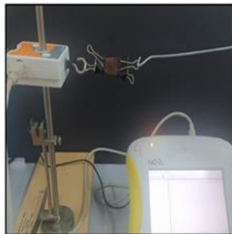
Resim 2.2. Gerilme mukavemet ölçümünde kullanılan cihaz (NOVA500).
