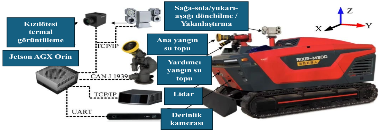
Şekil 5: Robot İtfaiye Aracının Teknik Özellikleri ve Donanımları
