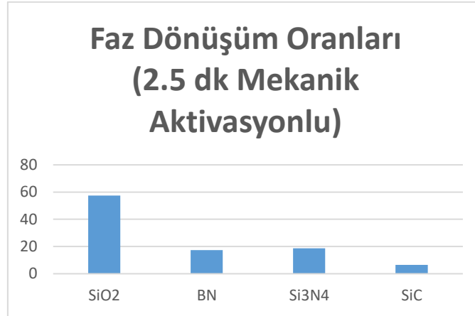
Şekil 7. 1420°C de 4 saat bekletilen 2.5dkx3 mekanik aktivasyonlu deneyin faz dönüş oranları (Figure 7. The change of amount of the nitrided silicon with changing BN ratio for the mechanical activated powder (2.5x3) at 1420°C for 4h)
