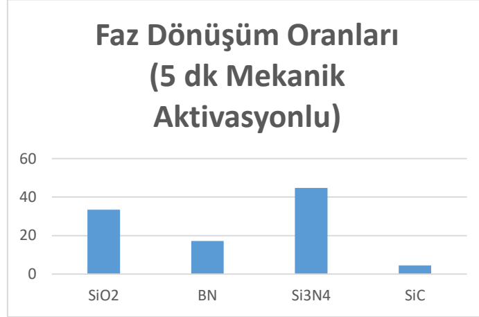
Şekil 10. 1420^\circ\text{C} de 4 saat bekletilen 5dkx3 mekanik aktivasyonlu deneyin faz dönüş oranları (Figure 10. The change of amount of the nitrated silicon with changing BN ratio at 1420^\circ\text{C} for 4h for mechanical activation (5x3))
