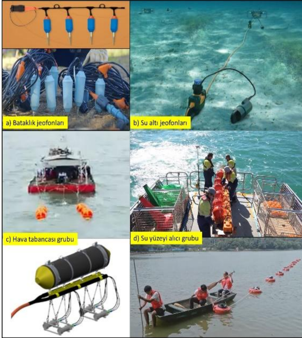
Şekil 8. Geçiş zonu kaynak ve alıcı ekipmanları; a) Bataklık jeofonları, b) Su altı jeofonları, c) Hava tabancası grubu, d) Su yüzeyi alıcı grubu, (GSI, 2025; Sercel, 2025; Smartsolo, 2025, Synterra Technologies, 2025; Offshore Energy, 2025)
