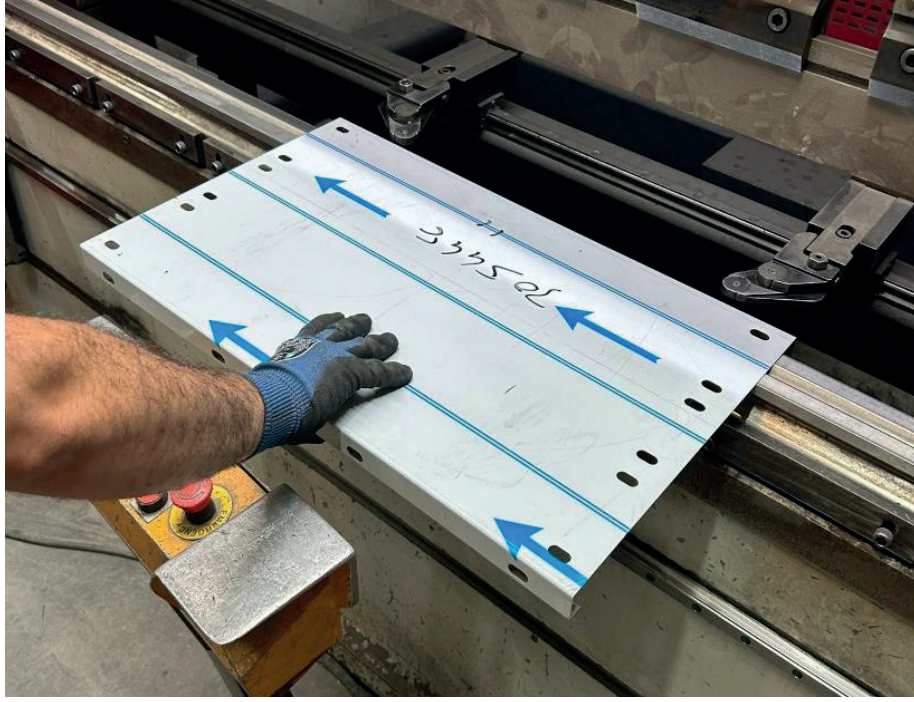
Şekil 11: Duvar, taban ve tavan saclarının ABKANT büküm makinesi ile işlenmesi
