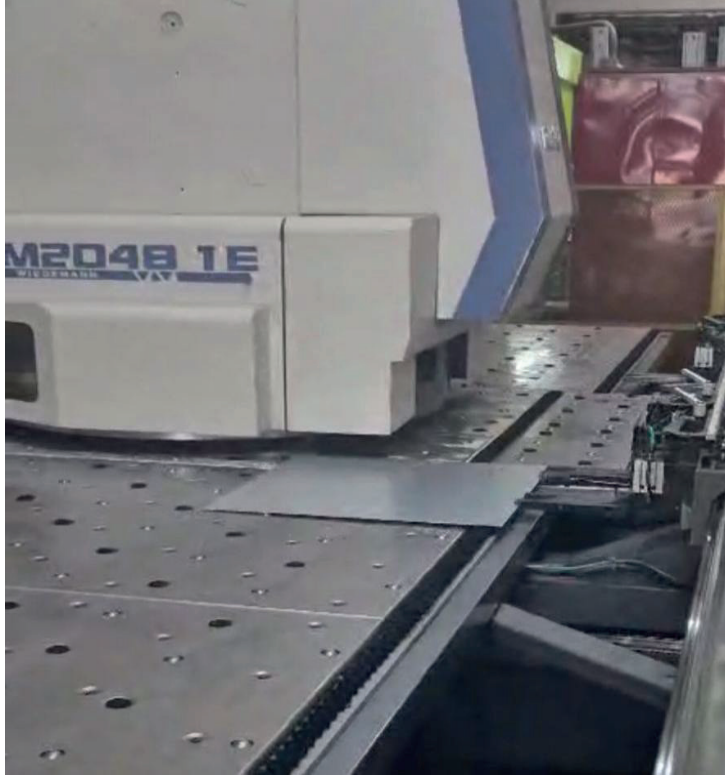
Şekil 9: Duvar, taban ve tavan saclarının PUNCH ile işlenmesi
