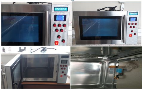
Şekil 6. UV sterilizasyon kabini dış, iç ve çalışma görüntüleri
