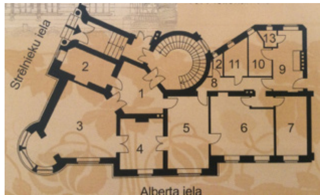
Şekil 1. Riga'da Strēlnieku Caddesi ile Alberta Caddesi köşesinde yer alan yarım daire cumbası kule ile bitirilen Art Nouveau Müzesi Mimar K. Pēkšēns'in (1859-1928) tasarımıdır. Mimarın yaşadığı daire müze olarak ziyaretçilere açıktır. Dairenin odalarının işlevleri bugün şöyledir: 1. Büyük Hol, 2. Ofis, 3. Salon, 4. Şömine Odası, 5. Yemek Odası, 6. Sergi Salonu, 7. Yatak Odası, 8. Koridor, 9. Mutfak, 10. Hizmetçi Odası, 11. Banyo, 12. Tuvalet, 13. Kiler.
