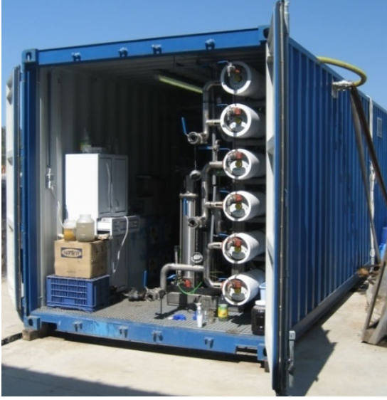
Şekil 1. Taşınabilir membran arıtma tesisi (Portable membrane treatment plant)
