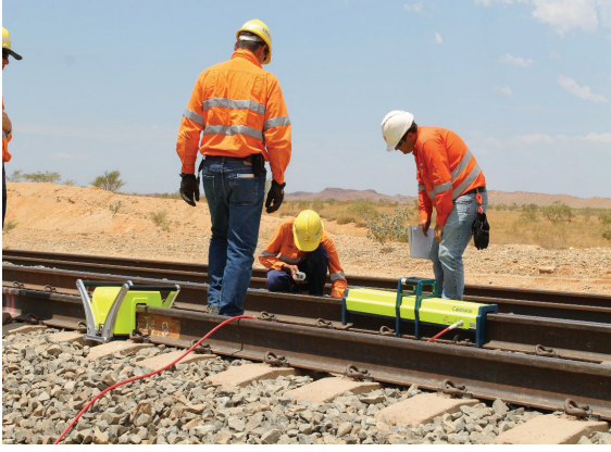
Resim 4 Raylarda gerilme ölçüm çalışmasından bir görünüm (Railstresstester BHP biliton Australia)
