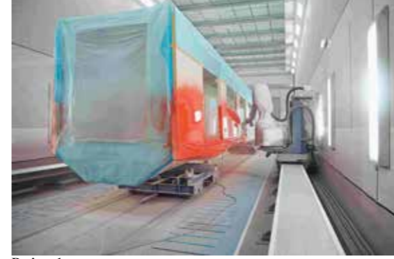
Robotik boya püskürtme işleminin yapıldığı bir Boyama-Kabini ve her iki yanda kızaklarla, üzerinde boyama robotu ve de kabin içerisinde son-kat-boyayla boyanan bir raylı taşıt aracının vagon gövdesi görülmekte.
