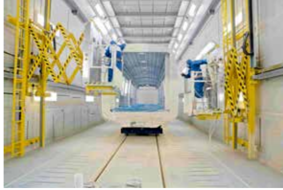
Elle/manuell boya püskürtme işleminin yapıldığı bir Boyama-Kabini ve her iki yan duvardan kılavuz yolu, makaslı tip infilaka karşı donanımlı boyacı personel-platformları ve de kabin içerisinde astar-boyayla boyanan bir raylı taşıt aracının vagon gövdesi görülmekte.
