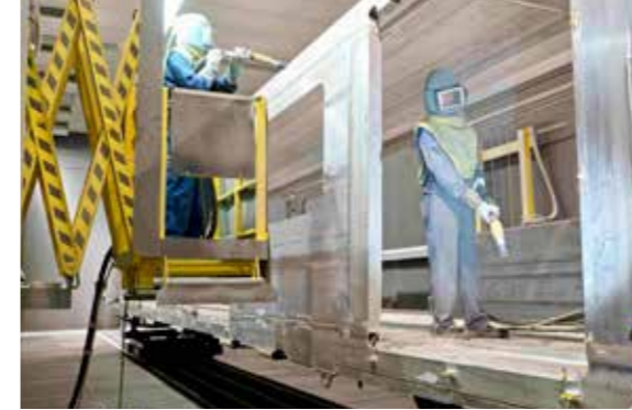
Yeni kurulan Serbest-Mekan-Kumlama-Kabini; her iki yan duvardan kılavuz yollu, ve makaslı iki adet kumlama Personeli-Platformları ile, raylı taşıt araçlarının Basınçlı-Havali-Kumlama metoduna göre işlenmesinde olağanüstü esneklik sağlamaktadır.
