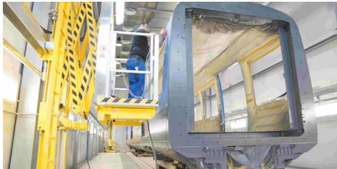
Elle/manuell boyama ve rötuş işleminin yapıldığı bir Boyama-Kabini ve her iki yan duvardan kılavuz yollu, makaslı tip infilaka karşı donanımlı boyacı personel-platformları ve de kabin içerisinde boya rötuş işlemi yapılan bir raylı taşıt aracının vagon gövdesi görülmekte.
