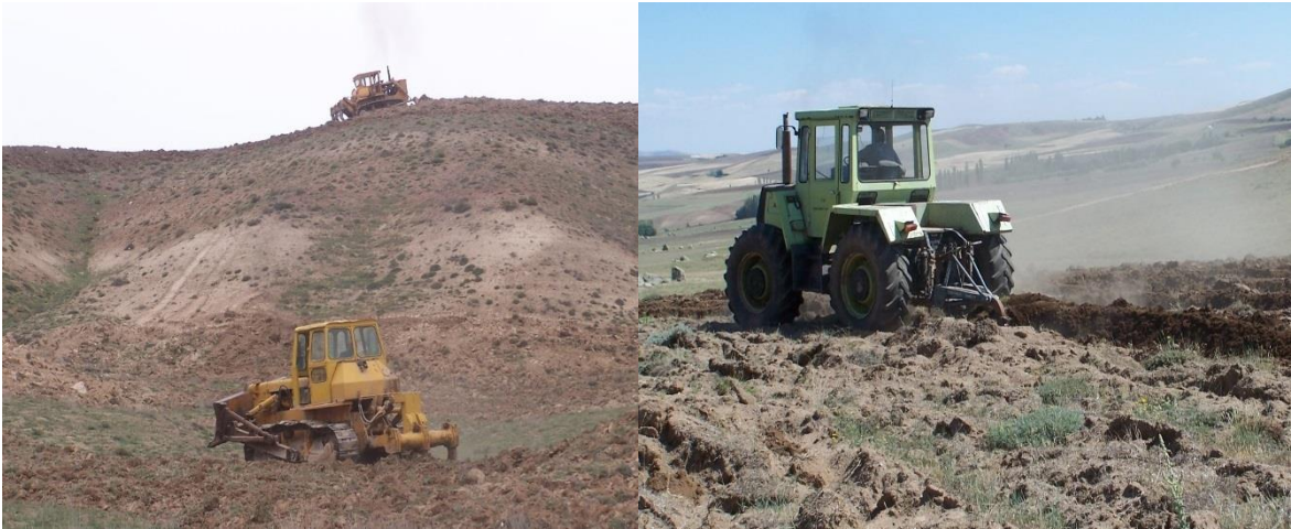
Şekil 10. İç Anadolu'da düşük eğimli arazilerde paletli ve lastik tekerlekli makinelerle alt ve üst toprak işleme
