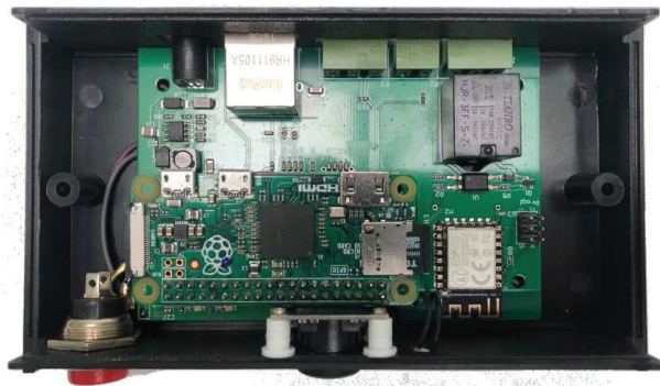
Şekil 4: Akıllı Pano Kontrol Kartının Donanım Yapısı.
