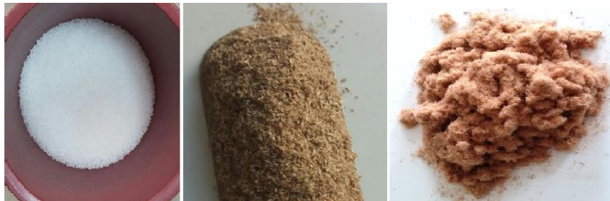
Şekil 1. Çalışmada kullanılan (a) polipropilen, (b) odun unu, (c) selüloz lifi
