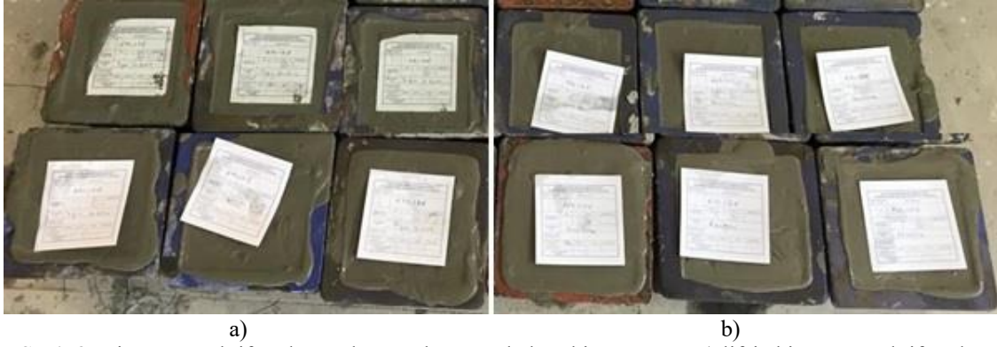
Şekil 3. Kireçtaşı reaktif pudra püskürtme betonun kalıptaki görünümü a) lifsiz kireçtaşı reaktif pudra püskürtme betonu (LIM-L1-PC) b) lifli kireçtaşı reaktif pudra püskürtme betonu (LIM-L2-PC)
