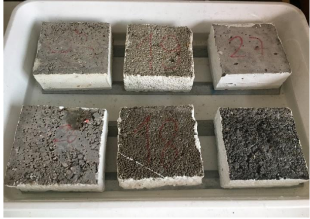
Şekil 3. Numunelere uygulanan kılcal su emme yöntemi
