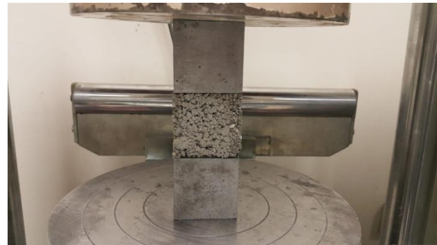
Şekil 2. Beton basınç dayanımının 50x50x50 mm'lik numuneler üzerinden test edilmesi
