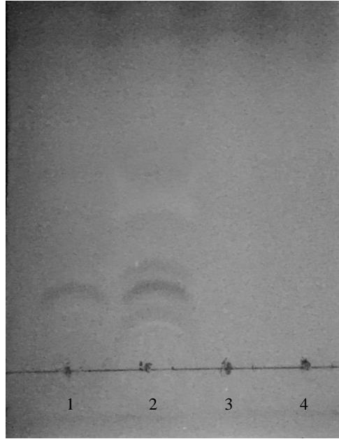
Şekil 4. İnce tabaka kromatografisi görüntüsü. 1: referans markırı, 2: kontrol grubu, 3: 10 µg mL -1 Kaempferol uygulanmış örnek ve 4: 20 µg mL -1 Kaempferol uygulanmış örnek.
