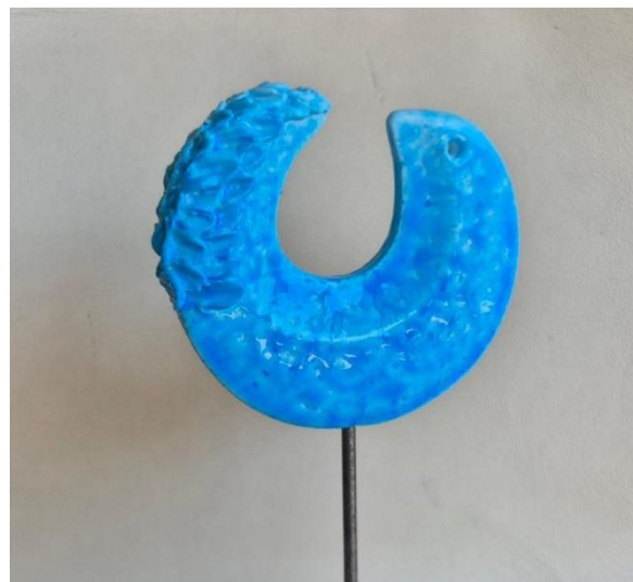
Görsel 9. Doğrudan bünyeyi renklendirme yöntemi ile sır geliştirme uygulama sonucu, 950 °C, 12 X 12 X 1 cm (Bilgi Avcı Arşivi, 2023)
