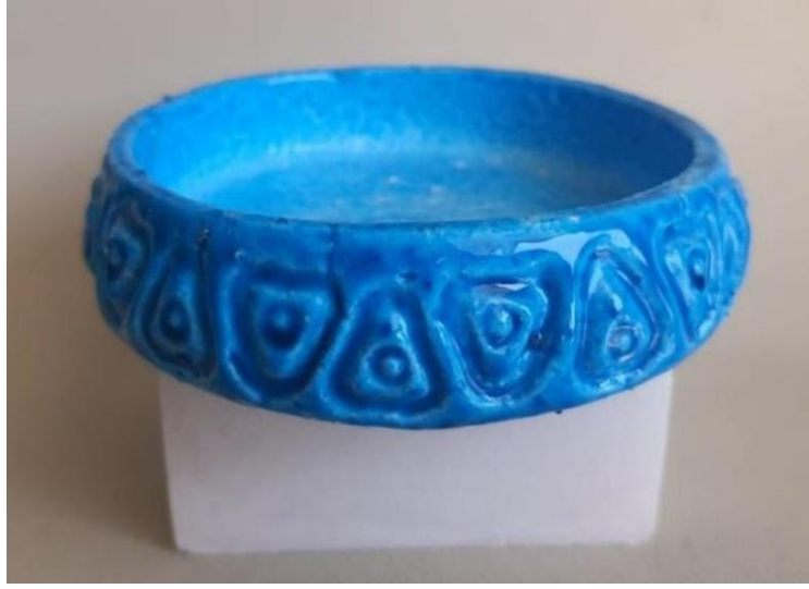
Görsel 4. Kuru sementasyon harmanı ile sır geliştirme uygulama sonucu, 950 °C, Ø 12 cm h: 2,5 cm (Bilgi Avcı Arşivi, 2023)
