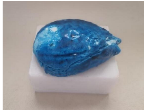
Görsel 8. Sulu sementasyon harmanı ile sır geliştirme uygulama sonucu, 950 °C, 9 X 6 X 3 cm (Bilgi Avcı Arşivi, 2023)
