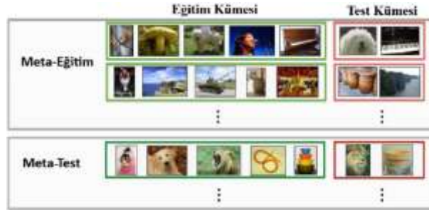
Şekil 2. Meta-öğrenmede eğitim ve test sürecinin, her biri küçük destek (support) ve sorgu (query) kümelerinden oluşan görevler üzerinden nasıl gerçekleştirildiğini gösteren şema (Ravi ve Larochelle, 2022)
