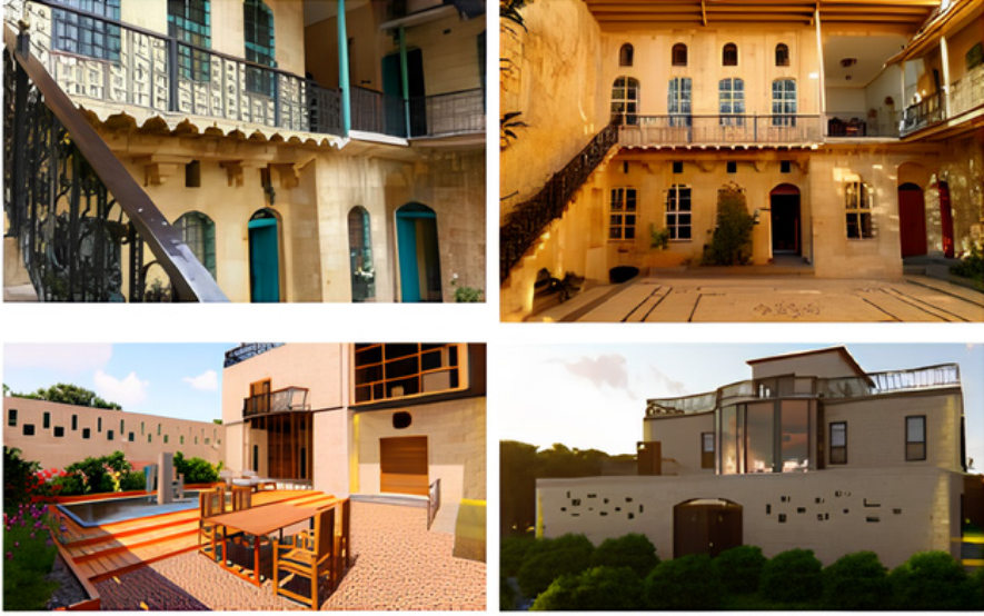
Şekil 18: Geleneksel Gaziantep konutu ile (yukarıdaki resim) ve yeni tasarlanan konutun (aşağıdaki resim) Kuş Penceresi, Yerel Taş Malzemesi, Ferforje Kullanımı, Müstakil Konutlarda Kemer ve Eyvan Tasarımı ile karşılaştırılması.
