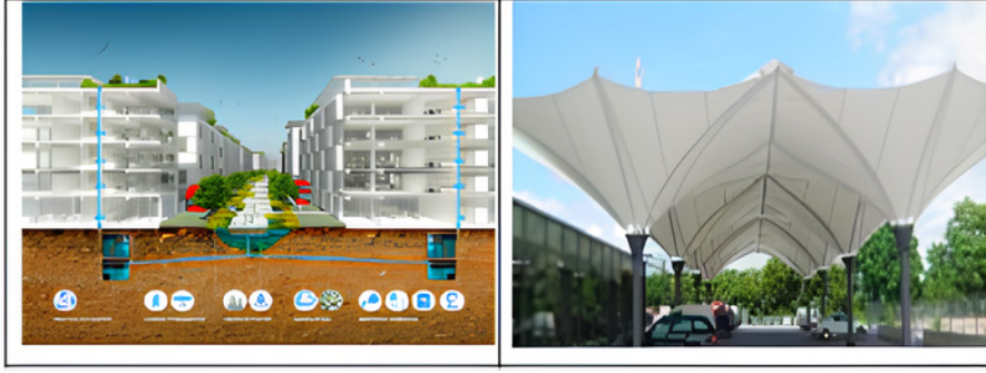
Şekil 23: Konut balkonlarında ve yeşil çatılarda sulama (solda) ve pazar yeri üst örtüsünde yağmur suyu toplamaya uygun elemanlar (sağda).
