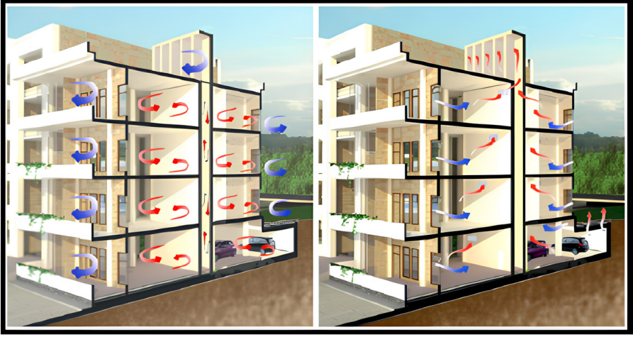
Şekil 6: Pasif ısıtma ve pasif soğutma prensipleri için toplu konutlarda özel baca sistemi.
