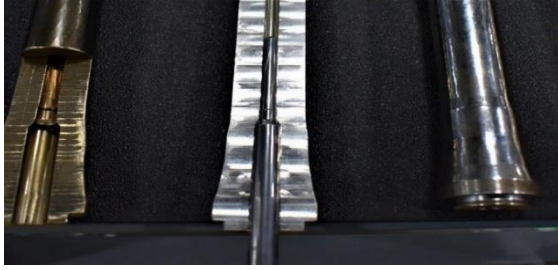
Şekil 2. Dövme metoduyla üretilmiş namludan hazne bölümü kesit alınmış görüntü, dövme malafasının kesit içinde görüntüsü, dövmeden çıkmış namlu görüntüsü [13].
