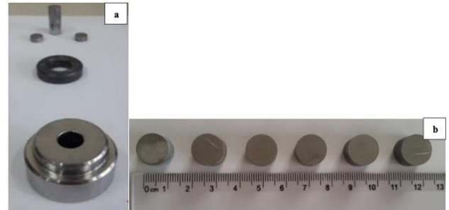
Şekil 1. (a) Tozların şekillendirilmesi için kullanılan silindirik kalıp, (b) şekillendirilmiş silindirik numuneler
