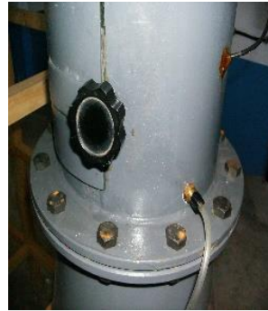
Şekil 8. a) Su manometresi b, c, d) Su manometresinin makina silosuna bağlantısı
