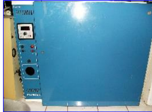
Şekil 7. Hasattan sonra küçük parçalara ayrılmış cevizin nemi belirlenen etüv
