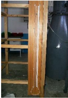
Şekil 8. a) Su manometresi b, c, d) Su manometresinin makina silosuna bağlantısı
