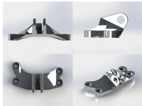
Şekil 8. Topoloji Optimizasyonu sonrası yeniden modellenen geometri
