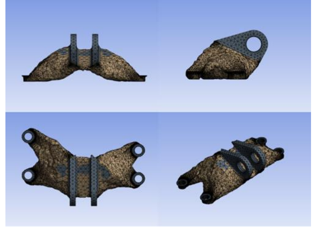
Şekil 7. Topoloji Optimizasyonu sonrası ham geometri
