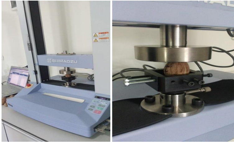
Şekil 1. Kabuk kırılma direncini ölçen aletten bir görünüş Figure 1. A view from the tool measuring the crust resistance
