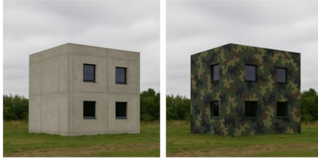
Şekil 4. Kamufraj uygulanmamış (solda) ve WZ.93 desenli kamufraj uygulanmış (sağda) yapı örneği (Serwatko ve ark. 2023’ten esinlenerek)
