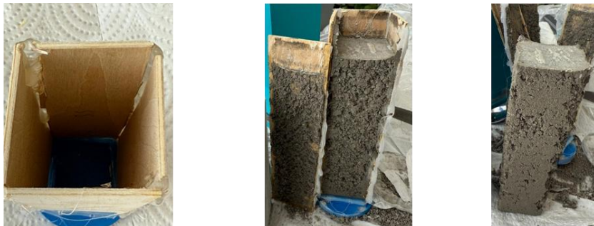
Şekil 12. Kontrplak Kalıbın Sökülmesi ve Yüzey Kalitesinin İncelenmesi
