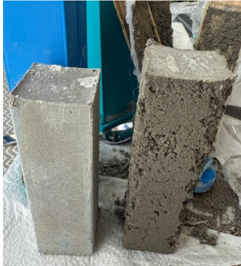
Şekil 14. Prefabrik Elemanların Üretim Sonrası Yüzey Kalitelerinin Kıyaslanması
