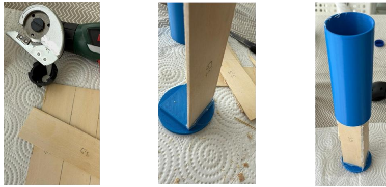
Şekil 11. Kontrplak Malzemeden Üretilmiş Kalıpların Montaj Süreci
