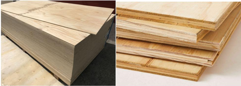
Şekil 4. Kontrplak Levha Örnekleri (İnşaatlarda Kalıp Üretiminde Sıklıkla Kullanılmaktadır)
