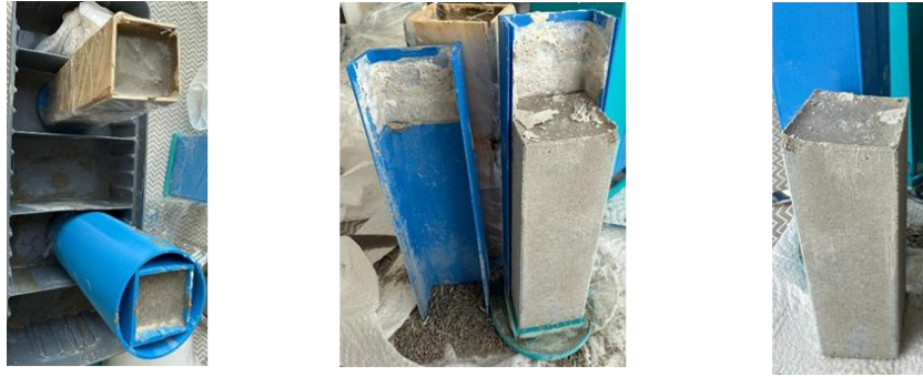
Şekil 10. ABS Kalıbın Sökülmesi ve Yüzey Kalitesinin İncelenmesi
