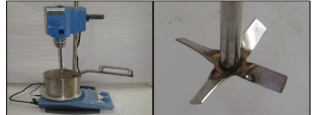
Şekil 2. Modifiye bitüm mikseri ve karıştırma başlığı
