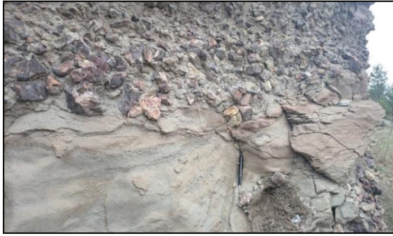
Şekil 9. Masif yapıda gözlenen kumtaşı ile kaba taneli çakıltaşı ardalanması (Kızılıbük Köyü güneybatısı).
