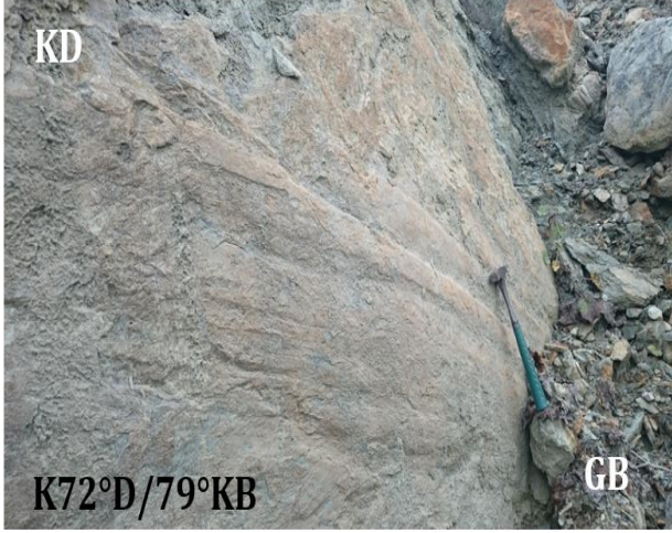
Şekil 23. Kızılıbük Köyü'nün güneyindeki K72°D/79°KB konumlu Bakacak Fayı düzlemi
