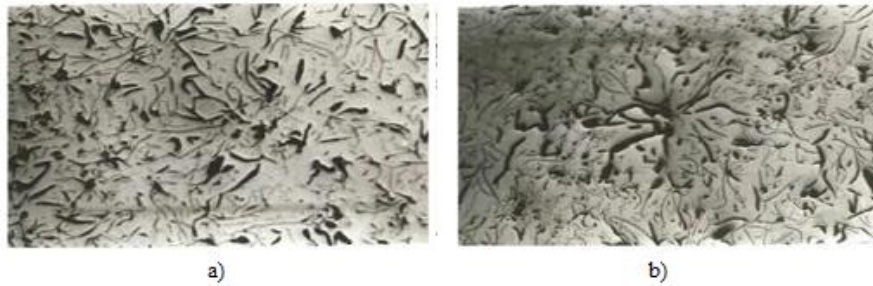
Şekil 1. (a) Dökme Demir Mikroyapısı (b) Bor ilave edilmiş gri dökme demir mikroyapısı [9] (a) Cast Iron Microstructure (b) Boron-added grey cast iron microstructure [9]
