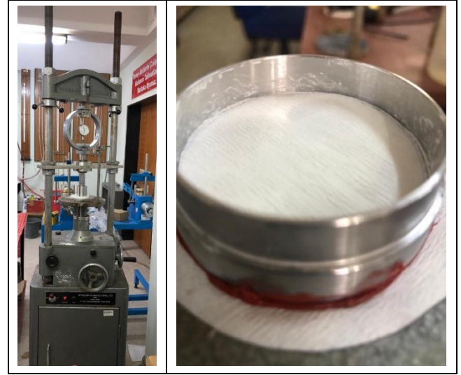
Şekil 2. Numunelerin sıkıştırılması. (a): Tek eksenli deney cihazı. (b): Sıkıştırılmış numune.
